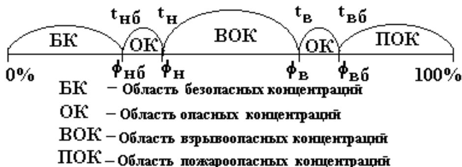
Рисунок 5.1 – Области температур жидкости и концентраций ее паров
