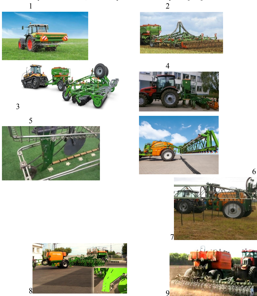
Рис. 1. Комплексы машин АО «Евротехника» для применения минеральных твердых и жидких удобрений по различным технологиям: 1-поверхностно равномерно по всей площади (твердые удобрения); 2-3-внутрисочвенно равномерно (твердые удобрения); 4-внутрисочвенно-локально (твердые удобрения); 5-локально-очагово (твердые удобрения); 6-поверхностно штанговым опрыскивателем по всей площади (жидкие удобрения); 7-внекорневая подкормка растений шлангами удлинителями опрыскивателем (жидкие удобрения); 8-внесение жидких удобрений одновременно с обработкой почвы и посевом, 9-инъеکتорное внесение (жидкие удобрения).
